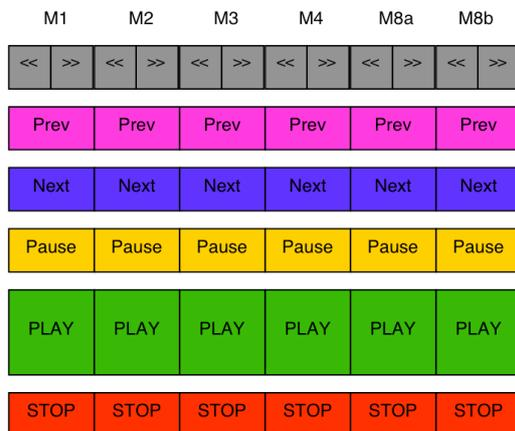
Im Vergleich hat die PLAY Taste der USB42 die Größe von 4 Knöpfen der bisherigen USB20 Remote, STOP,PAUSE,NEXT,PREV haben die Größe von 2 Knöpfen. Dabei werden die ersten 6 Maschinen unterstützt (auf Wunsch kann auch eine Maschine durch den Mediaplayer ersetzt werden).
