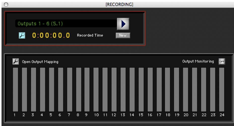
Hiermit erlaubt TH-S CL/XL4 sehr schnelles und komfortables Recording/Mixing innerhalb derselben Applikation. Durch Anwahl des Aufzeichnungsformats im grünen Popup Menü wird ein entsprechendes Mehrspurfile erzeugt (1 - 3x 8Kanäle Interleaved) und die Recording Engine auf Aufnahme gestellt (blinkender Record button).
